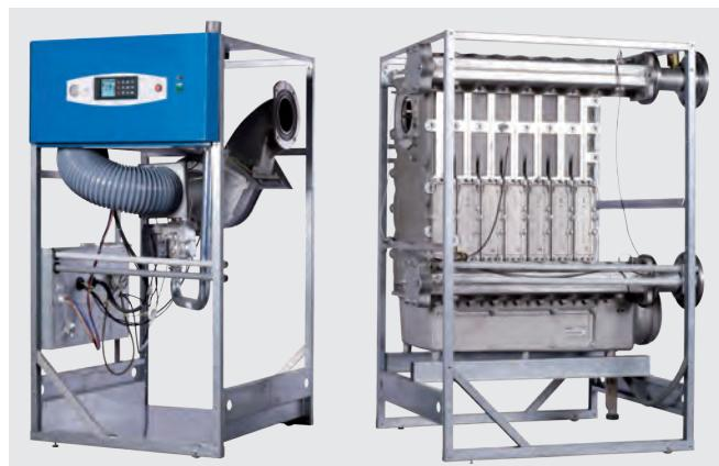
Sorella maggiore dell'Alubongas 1, AluBongas 2 è una caldaia a condensazione con potenze da 336 a 620 kW e scambiatore primario a bassissimo contenuto d'acqua in lega d'Allumino, Silicio e Magnesio da 5 a 9 elementi realizzato per assicurare elevati rendimenti medi stagionali.
